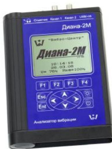
Рисунок 1 - Внешний вид анализатора вибрации двухканального «Диана-2М»
