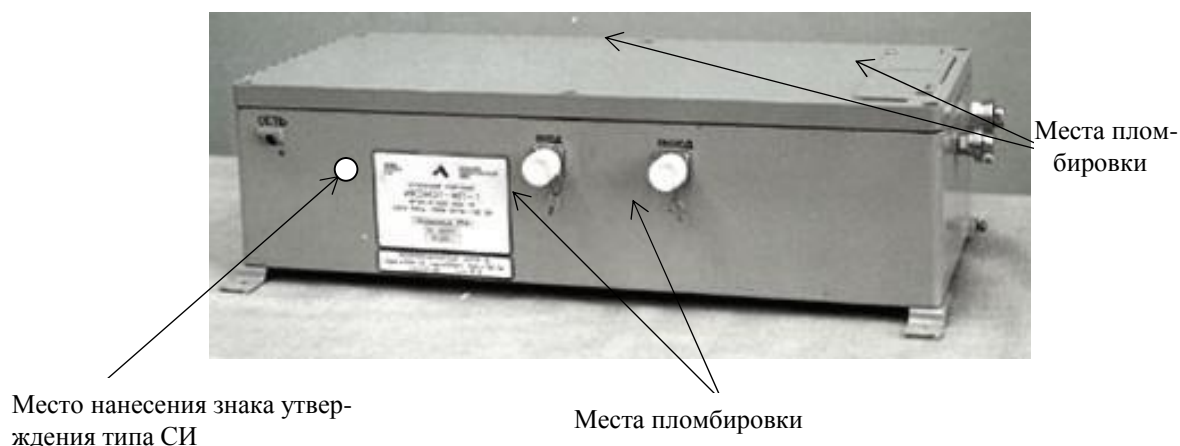
Рисунок 2. Схема места нанесения знака утверждения типа и мест пломбирования спиртомера
