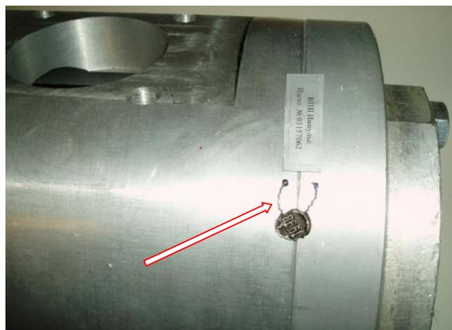
Рисунок 7 – Места пломбировки первичных преобразователей OP-400\1000-Э, Т
