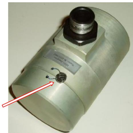
Рисунок 6 – Места пломбировки первичных преобразователей OP-2\40\100-Э, Т
