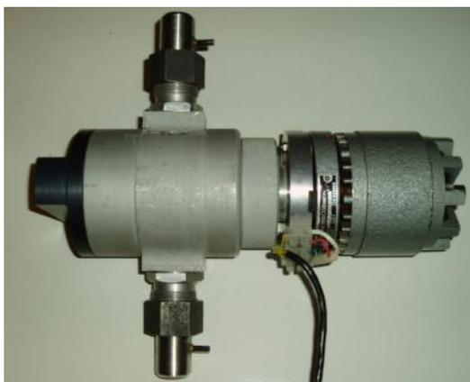
Рисунок 4 – Фотография общего вида первичного преобразователя OP-40-Э, Ду = 20 мм
