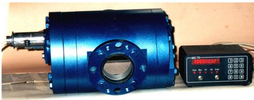
Рисунок 3 - Фотография общего вида расходомера OP 1000 модификаций С и Т с комплектацией вторичным прибором MC-75
