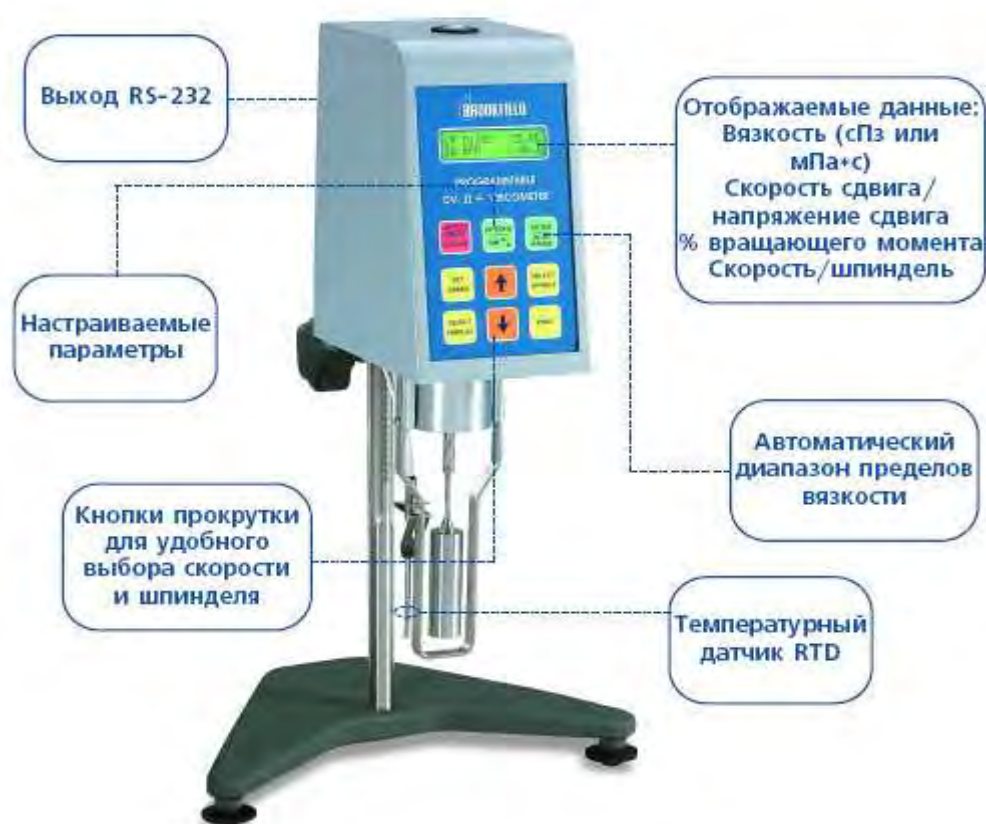
Рис. 1 Общий вид вискозиметров Брукфильда ротационных DV-II+PRO.
