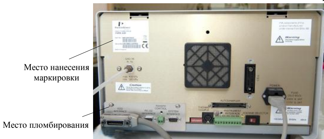
Рисунок 2 - Место нанесения маркировки и место пломбирования Систем проточно-инжекционных FIMS модификации FIMS-100 и FIMS-400
