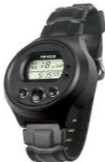
Рисунок 1 - Внешний вид дозиметра гамма- излучений ДКГ-РМ 1603
