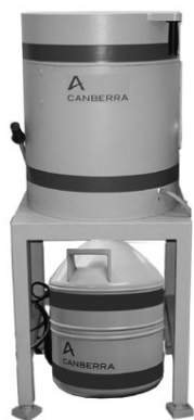
Полупроводниковый блок детектирования с азотным охлаждением в экран-защите 747
