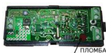
г) Плата преобразователей ИТ-2.хР (крышка снята)
