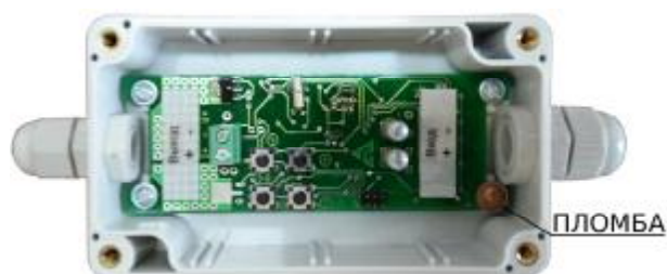
в) Плата преобразователей ИТ-2.хД (крышка снята)
