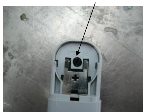
Рисунок 3 – Схема маркировки и пломбировки тонометра
