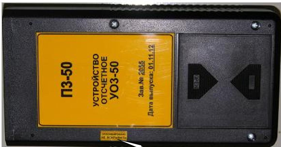
Место пломбировки от несанкционированного доступа
