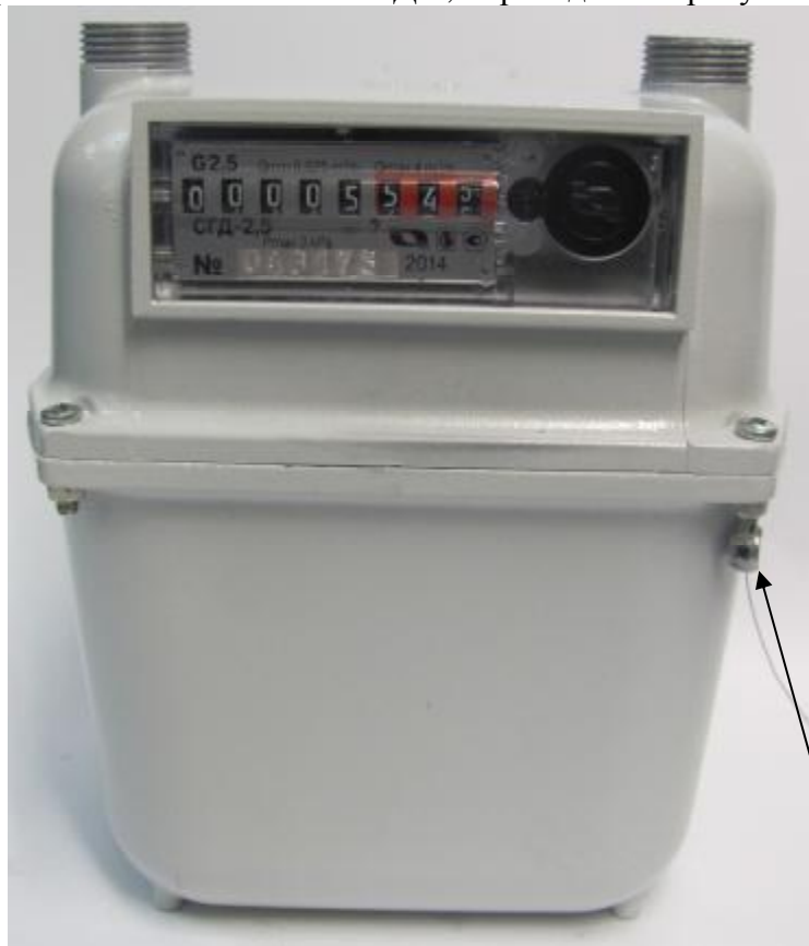
Место пломбирования и нанесения оттиска знака поверки
