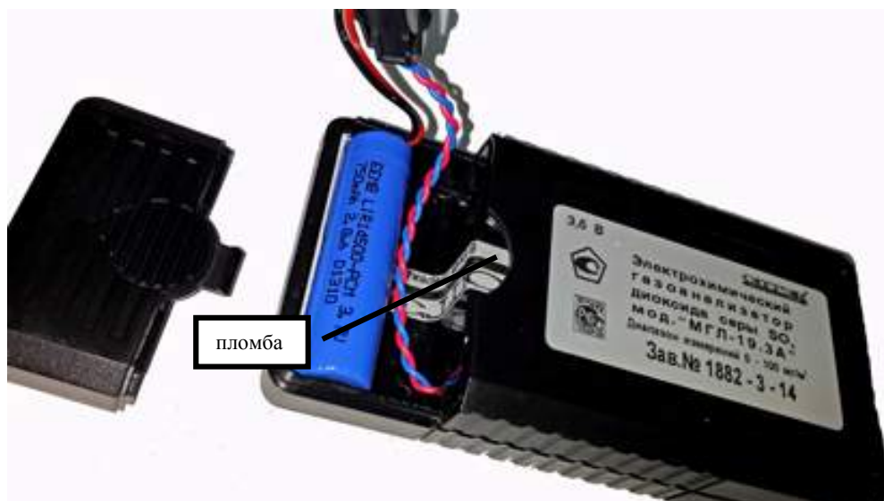
Рисунок 2 – Схема пломбировки газоанализаторов
