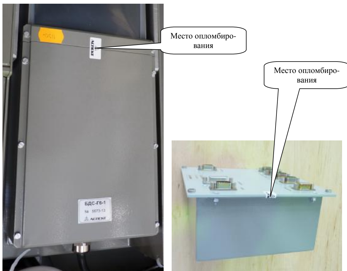
Рисунок 1 – Места опломбирования стойки и находящегося в ней блока БПО (местонахождение микропроцессора и энергонезависимой памяти)
