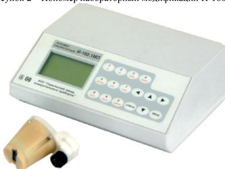
Рисунок 3 – Иономер лабораторный модификации И-160.1МП
