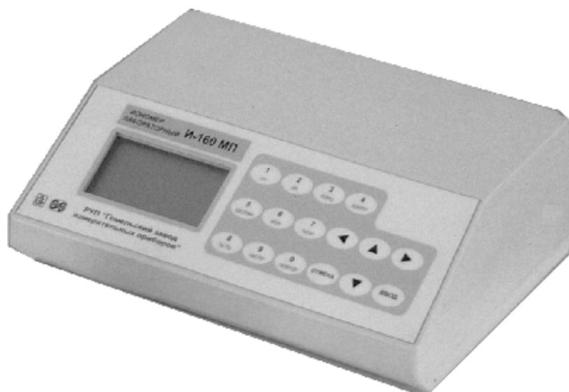
Рисунок 2 – Иономер лабораторный модификации И-160МП
