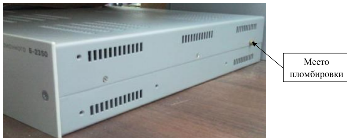
Рисунок 2 – Схема пломбировки генераторов от несанкционированного доступа.
