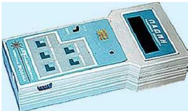
Рисунок 1 - Общий вид дозиметров лазерных автоматизированных для контроля уровней импульсного и непрерывного излучения «ЛАДИН»
