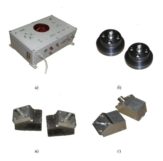
Рисунок 1 - Внешний вид сигнализаторов уровня ультразвуковых УЗС а) электронный блок
