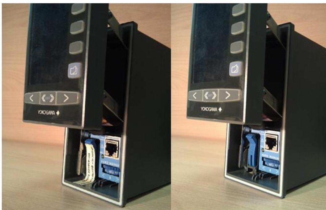
Рисунок 3 – Фотографии места пломбирования контроллеров
