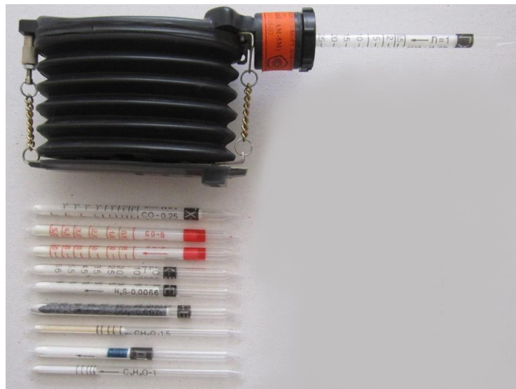
Рисунок 1 – Общий вид газоопределятеля химического и трубок индикаторных
