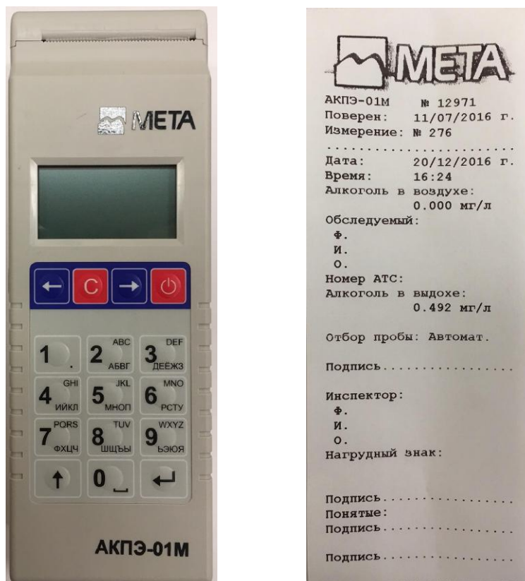
Рисунок 4 – Общий вид анализатора АКПЭ-01-«Мета» модификация АКПЭ-01М исполнение АКПЭ-01М-03 и пример распечатанного протокола измерения
