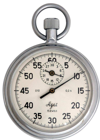
Секундомер механический типа СОПпр
