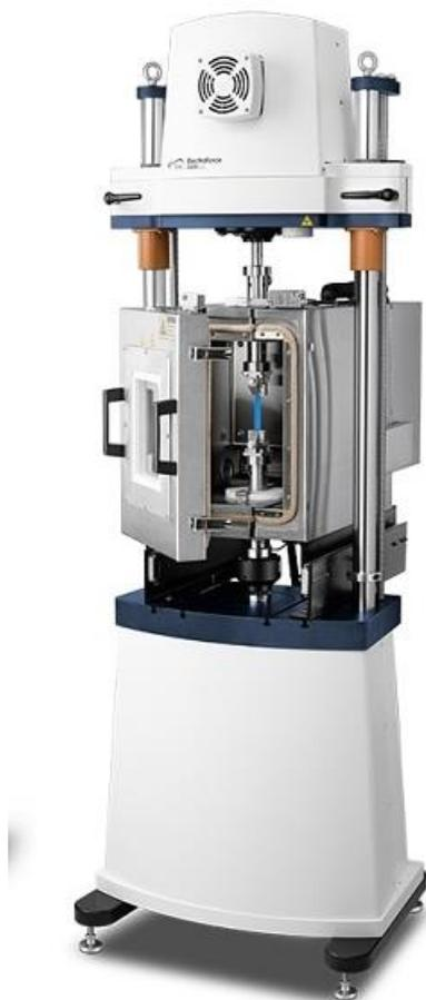
Рисунок 3 – Общий вид измерительного блока анализатора динамического механического DMA Electroforce 3300
