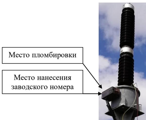
Рисунок 1 – Общий вид средства измерений с указанием (при наличии) мест пломбировки, мест нанесения знака утверждения типа, знака поверки, заводского номера
