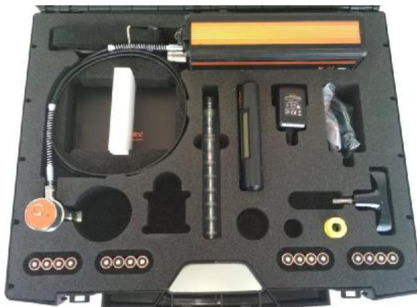
Рисунок 2 - Общий вид адгезиметра гидравлического автоматического Elcometer 510 в кейсе для транспортировки
