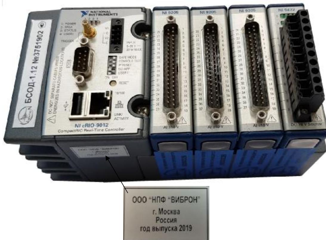
Рисунок 1 - Общий вид блоков сбора и обработки данных БСОД-1.xx - четырехмодульное исполнение корпуса и маркировочная табличка
