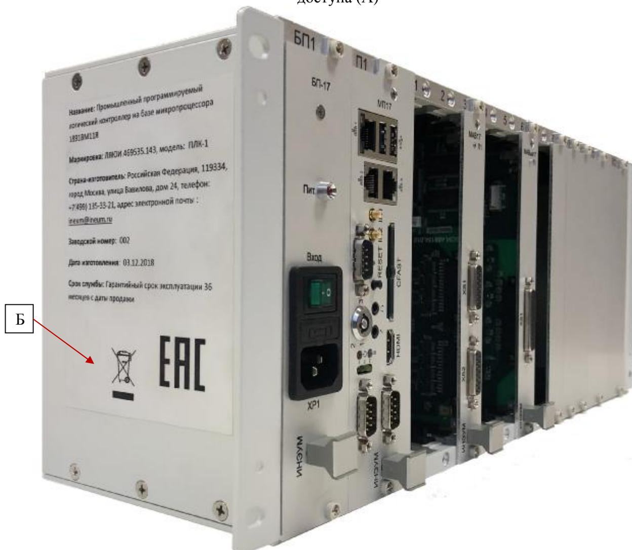
Рисунок 2 – Место нанесения знака утверждения типа (Б)
