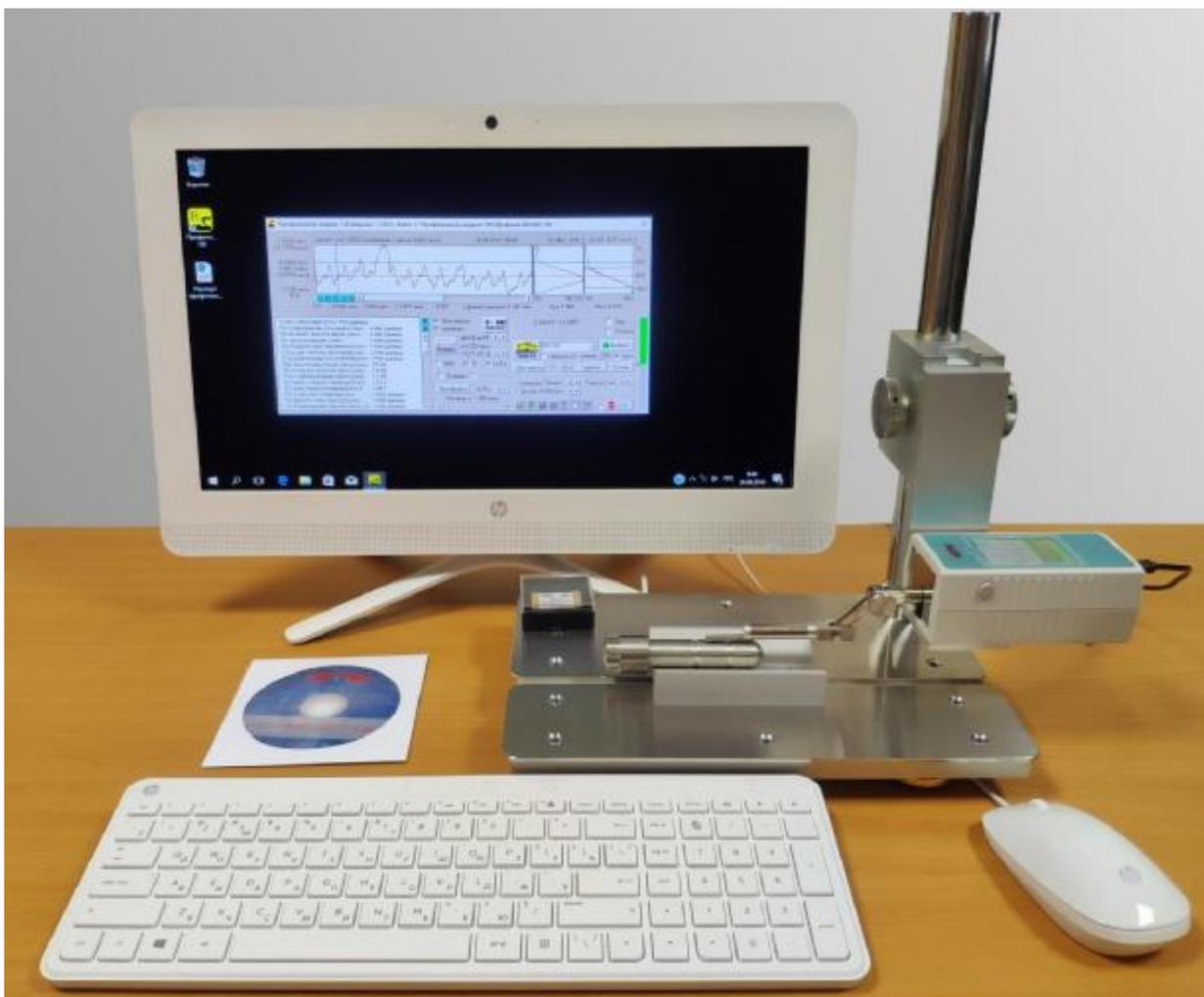
Рисунок 1 – Общий вид профилометров модели 130
