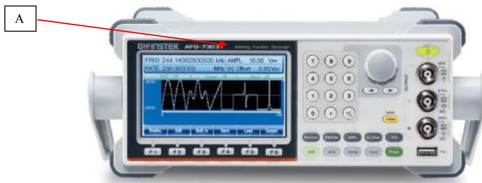
Рисунок 1 – Общий вид генераторов AFG-73021, AFG-73031 и место нанесения знака утверждения типа (А)
