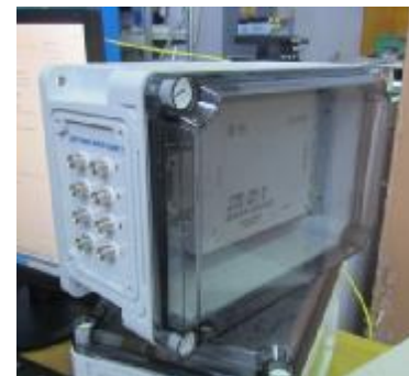
Рисунок 5 – Блок измерительный вибрации
