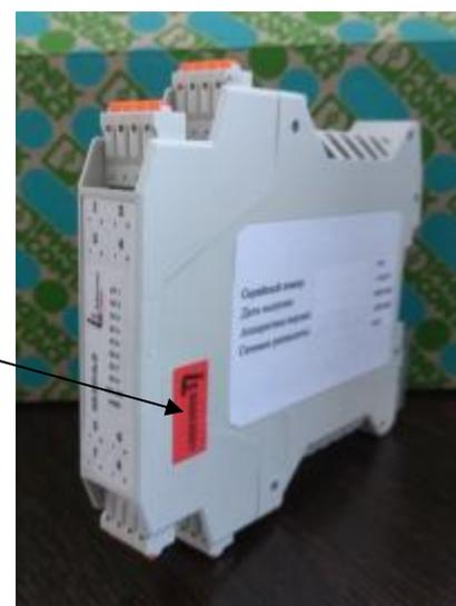
Рисунок 3 – Общий вид модулей ISS.DIO с обозначением схемы пломбировки от несанкционированного доступа для серии Standard
