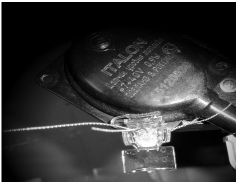
Рисунок 2 – Схема пломбировки от несанкционированного доступа, обозначение мест установки пломбы завода-изготовителя (знака поверки), место пломбирования крепежного болта
