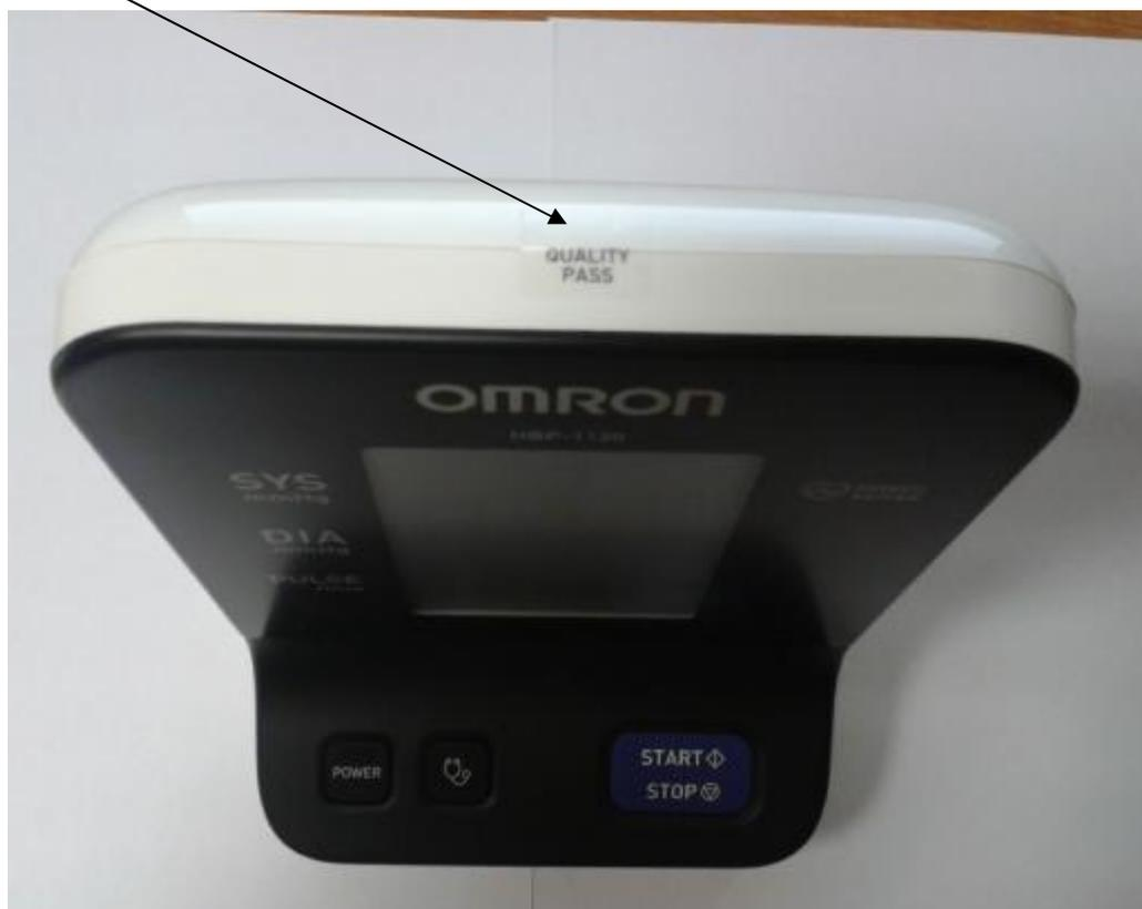
Рисунок 3 – Место нанесения защитной наклейки от несанкционированного доступа
