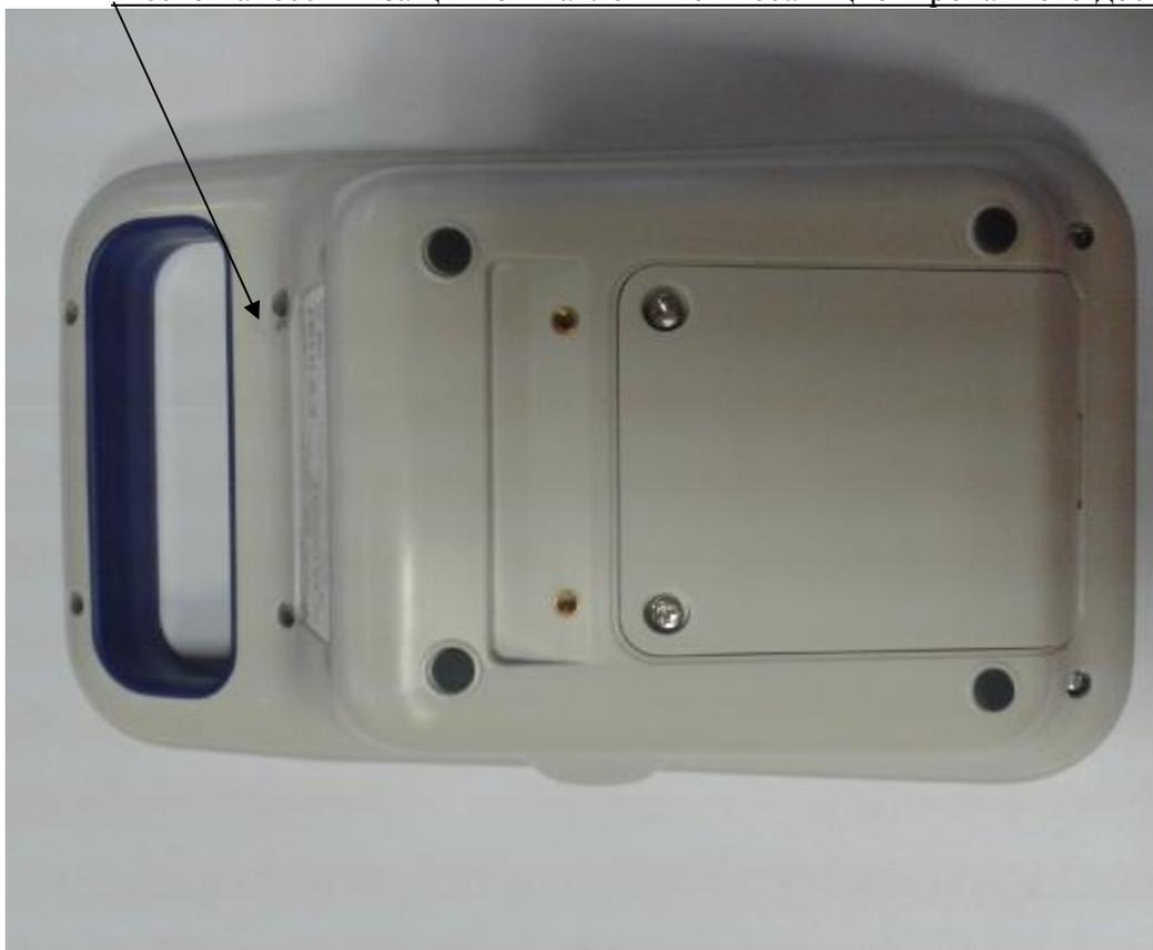
Рисунок 4 – Место нанесения защитной наклейки от несанкционированного доступа
