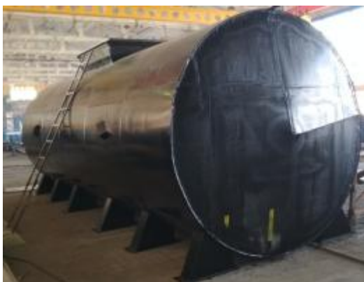
Рисунок 3 - Резервуары наземного исполнения
