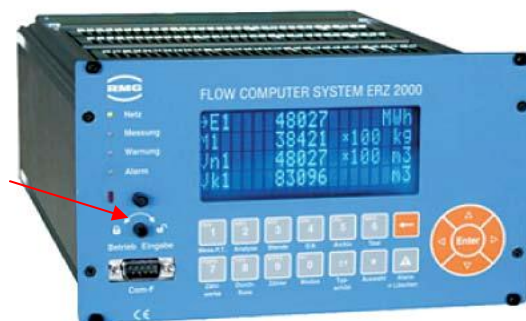
Рисунок 3 - Пломбируемый аппаратный переключатель корректора ERZ2000
