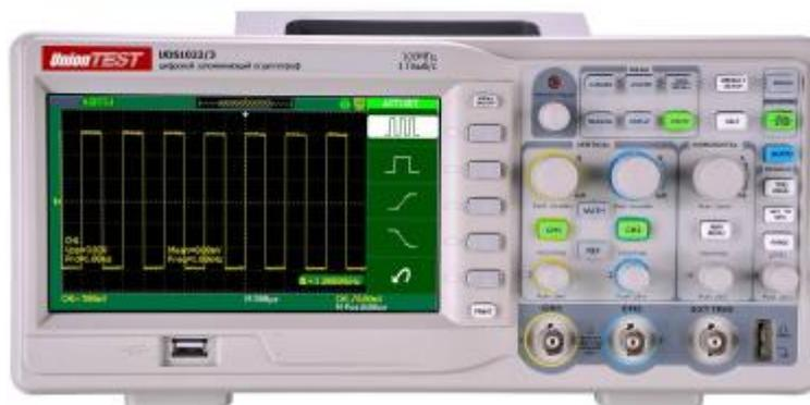
Рис. 1 Внешний вид осциллографов цифровых UDS1000
