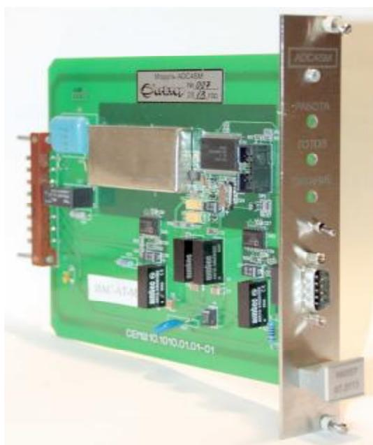
Рисунок 1. Модуль ввода аналоговых сигналов ADC4SM
