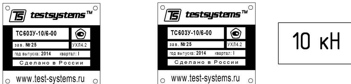
Маркировка динамометра на преобразователе      Маркировка динамометра на упругом элементе датчика
